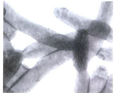
Die Legionellenfilter verfügen über Poren im Nanometerbereich. Im Bild sieht man Legionellen, die auf den Poren eines Seccuafilters liegen. Die Legionellen passen nicht durch die Poren
