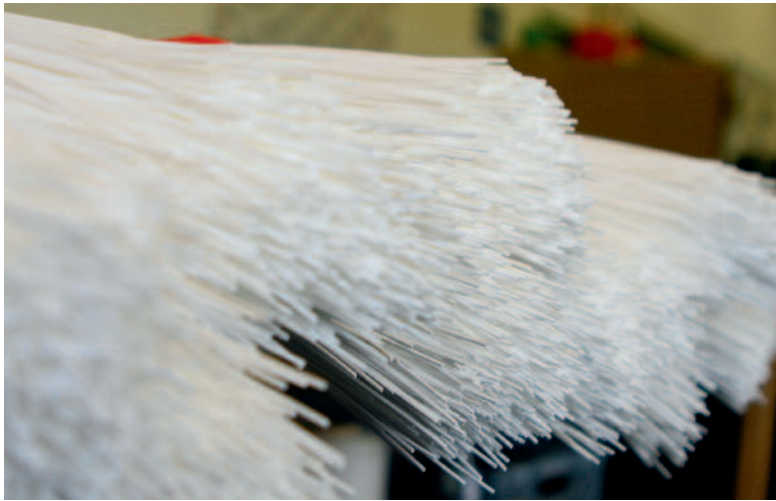
Die innen hohlen Membranfasern aus Kunststoff haben eine Porengröße von nur 20 Millionstel Millimeter Durchmesser. Zum Vergleich: Ein menschliches Haar ist 60.000 Millionstel Millimeter dick.
